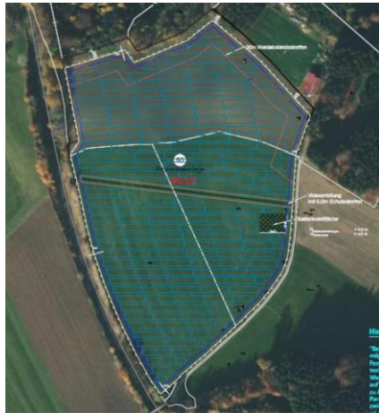
Abbildung 2: Luftbild inkl. Darstellung der Freiflächen-Photovoltaikanlage; vorgesehene PV-Module reichen in den Waldabstandsbereich (rot) auf 15 m hinein.
